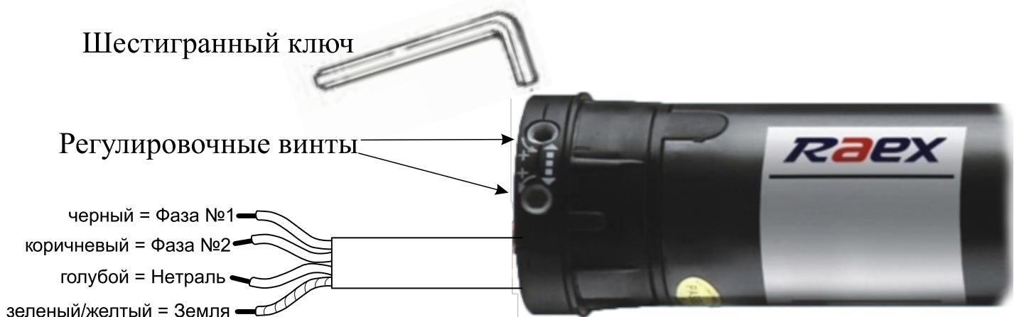
Каждому из регулировочных винтов механизма конечных положений присвоена соответствующая стрелка направления движения. Настройка осуществляется при помощи вращения регулировочного винта шестигранным ключом в соответствующем направлении. Поворот регулировочного винта в направлении + (плюс) увеличивает диапазон движения привода. Поворот регулировочного винта в направлении - (минус) уменьшает диапазон движения привода.
